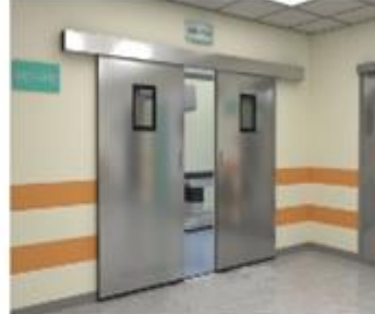
ÇİFT (İki) KANAT HERMETİK KAPI; İki yanın ve ölçünün müsait olması durumunda tercih edilebilir. (İki yandaki alanın kapı boşluğunun en az yarısı kadar olması gerekir)
